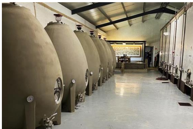
赤ワインの発酵に使う、コンクリートタンクと卵型のコンクリートタンク
